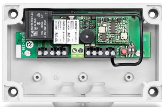
Modulo ricevente per il controllo degli attuatori per finestre
