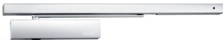
Chiudiporta aereo con braccio a slitta per porte ad un'anta facili da aprire e con assenza di barriere, con larghezza anta di fino a 1250 mm con magneti di ritenuta in aperto e centralina rilevatore fumo
