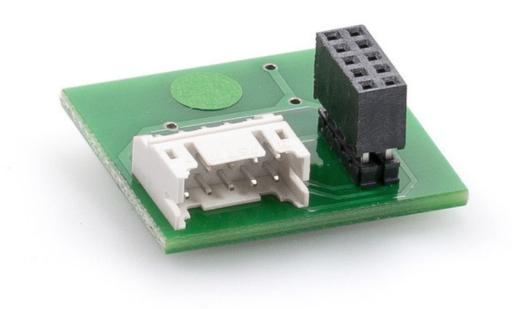
Scheda di interfaccia a innesto per la commutazione in serie di un massimo di due rilevatori combinati autocontrollati GC 363 SF
