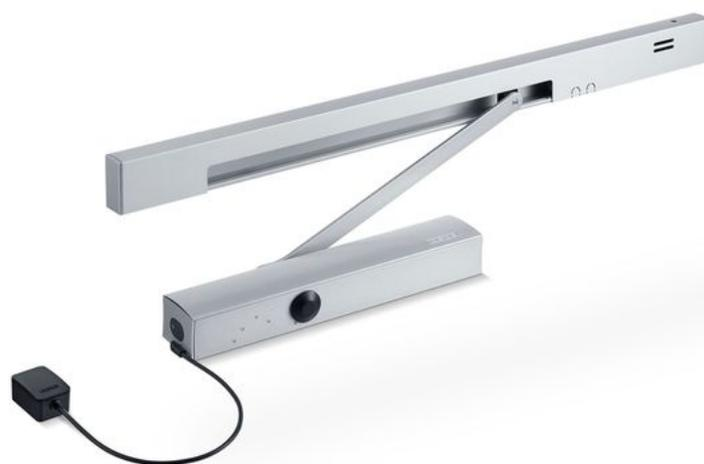
Chiudiporta aerei con braccio a slitta EN 3-6 con funzione free swing elettrica e centralina rilevatore fumo
