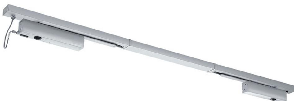
Sistema chiudiporta aerei con braccio a slitta lato opposto cerniera per porte a due ante con funzione antipánico, sporgenza cerniere max. 2800 mm con GEZE barra di trascinamento CB flex, regolazione della sequenza di chiusura integrata e unità elettrica di blocco in aperto.
