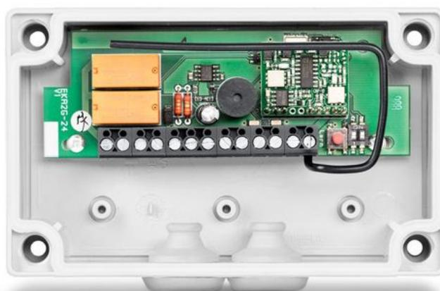
Modulo ricevente per il controllo delle porte automatiche e degli attuatori per finestre da 24 V DC
