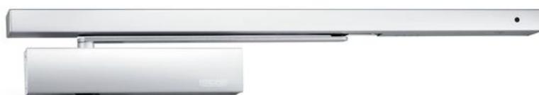
Chiudiporta aerei con braccio a slitta lato opposto cerniera per porte a un'anta con larghezza dell'anta max. 1400 mm con unità elettrica di blocco in aperto e interruttore antifumo
